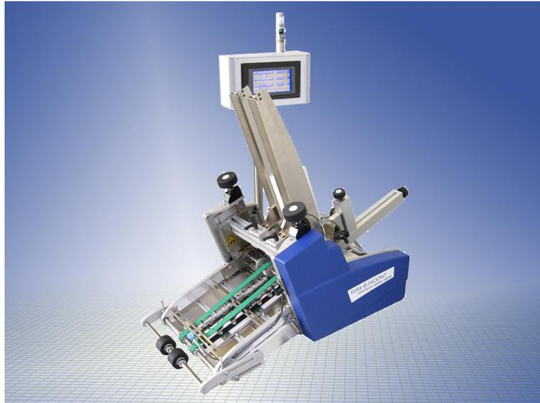
**Margeur pour les installations de distribution et de collage, pour positionnement précis des produits sur un produit porteur**
